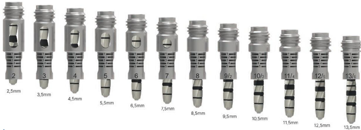
**FIG. 2.** Intercambiando los Drivers es posible variar la parte de la fresa que queda fuera, es decir, la profundidad efectiva de fresado. La zona de control de profundidad de los Drivers varía de mm en mm. Adicionalmente, durante su roscado en el conector (al unirlo al contra-ángulo) es posible realizar ajustes para adaptar su extremo inferior (el que toca con la cresta ósea) a las marcas de profundidad de las fresas.
