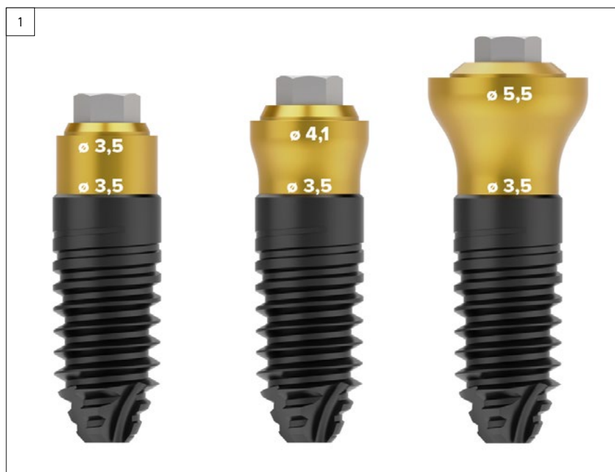
Figura 1. Implantes BTI-Core de 3,5 mm de diámetro con la plataforma protésica lograda con las diferentes anchuras de los transepiteliales, desde una emergencia recta a 3,5 mm, hasta una plataforma universal de 4,1 mm y una expandida que abre desde 3,5 mm del implante a 5,5 mm de la prótesis.
